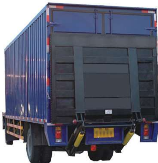
图 2-45 收起状态的水平长度不超过 300 mm 的尾板、上下坡道及类似装置
