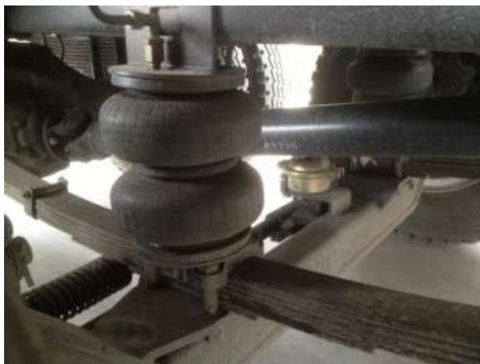
图2-5 空气悬架和钢板弹簧悬架复合设置
