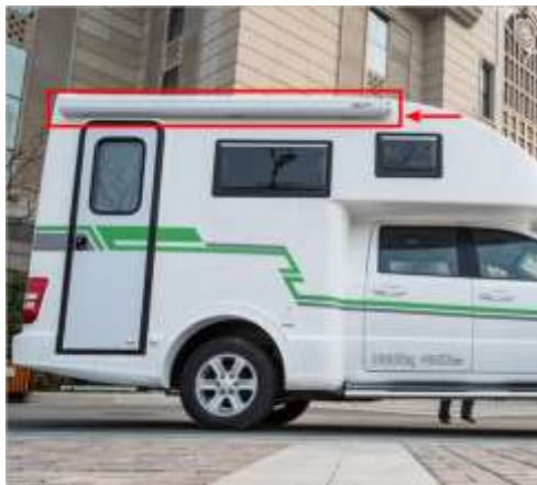
图 2-35 外部遮阳装置
