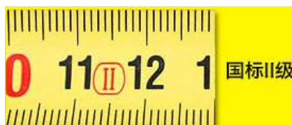
图 2-31 准确度 2 级的钢卷尺
